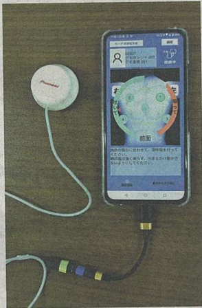
呼吸音を遠隔で測定できる電子聴診器。スマートフォンに接続して使用する
